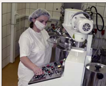
Výrobu krému zajišťuje ve speciálním zařízení vedoucí laboratoře se svým týmem. Krémy se z hygienických důvodů vyrábí vakuu.
