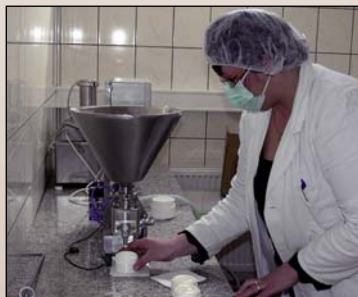
Při plnění vyrobeného krému přesné dávkování zajišťuje poloautomatická plnička. Laborantkám zůstane na starosti již jen přisun potřebných, vydesinfikovaných dóz
