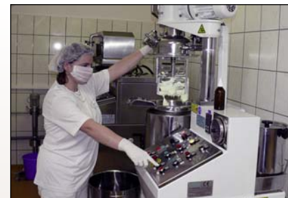
Po ukončení výroby krému hydraulika stroje zvedne míchací jednotku.
